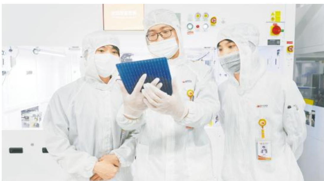
成都公司电池九厂A班丝网组成员检查电池片
